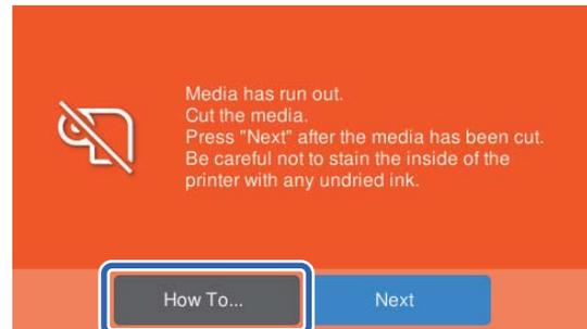
Nach dem Schneiden drücken Sie **Weiter** und ziehen das abgeschnittene Material nach unten, um es zu entfernen. Achten Sie darauf, dass nicht getrockneten Druckteile nicht in das Innere des Druckers gelangen.
