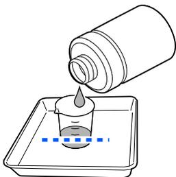
**3** Befeuchten Sie den Reinigungsstab mit Tintenreiniger.
